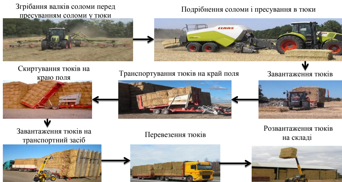
Рис. 1 Технологічна лінія заготівлі соломи використання її у біогазових установках
